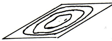
sections horizontales de la toiture
